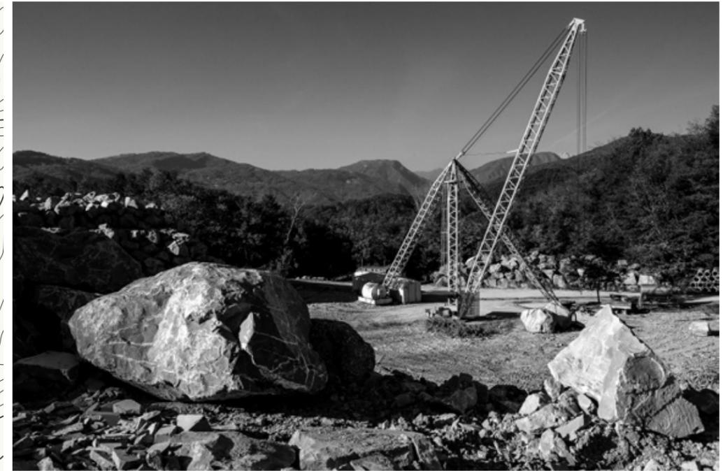
Fig. 19 – La cava di San Leonardo di Clastra con le gru per il sollevamento dei blocchi. / The San Leonardo di Clastra quarry with the crane for lifting blocks.
