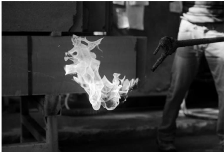
Fig. 37 / 38 – La fiammatura è una delle finiture realizzate da laconcig. / Flaming is one of the finishes offered by laconcig.
